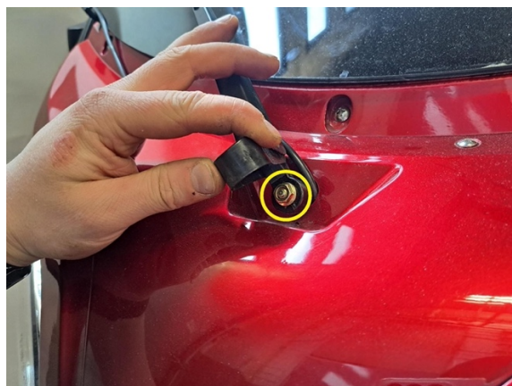
Irrota tuulilasinpyyhkijän kiinnitysmutteri. (hylsy 10 mm).
