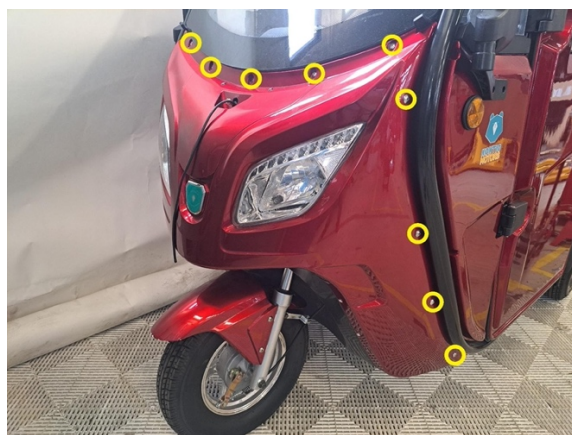
Irrota etukatteen kiinnitysruuvit kummaltakin sivulta ja tuulilasin edestä. (ristipäämeisseli ph2).
